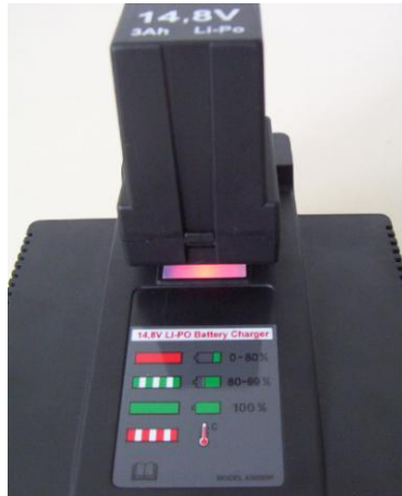
Début du chargement automatique, LED rouge sur affichage.
